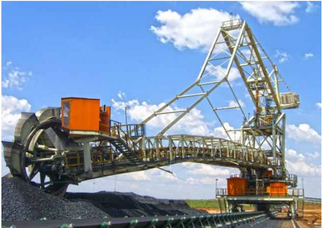
Εικόνα 4.4: Ένας τυπικός στοιβαχτής / αποστοιβαχτής
