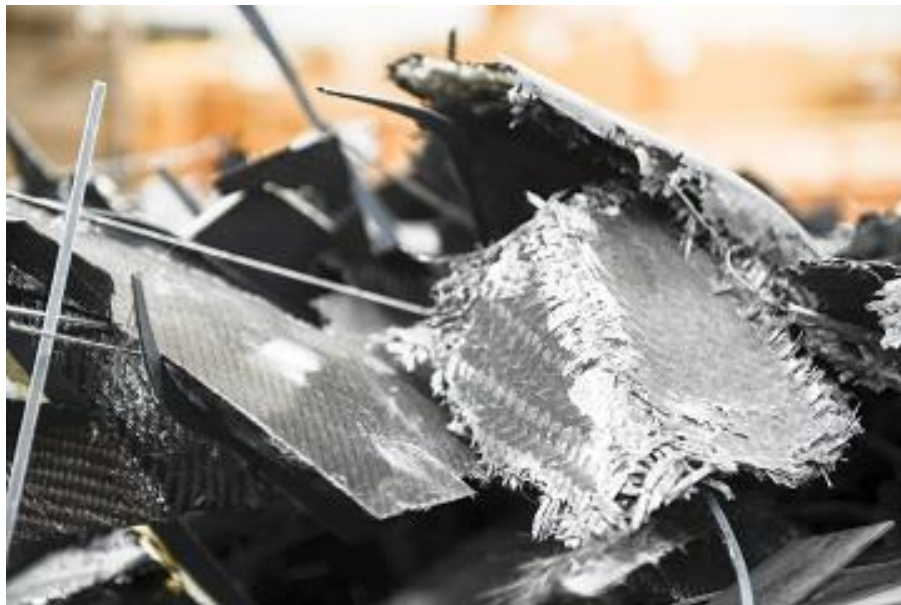
Εικόνα 4-1: Σκραπ ινών άνθρακα έτοιμα για τεμαχισμό και επεξεργασία ανάκτησης ινών (Πηγή: Recycled Carbon Fibre )
